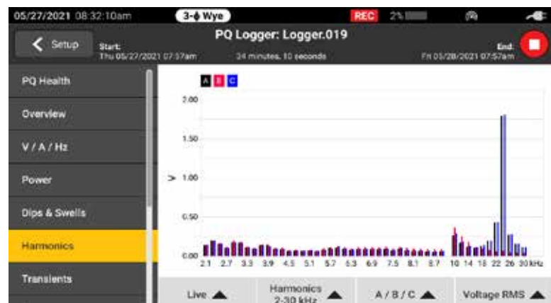
Beragam harmonisa lengkap tersedia dari 50 harmonisa integer pertama dan dari 2 kHz hingga 30 kHz
